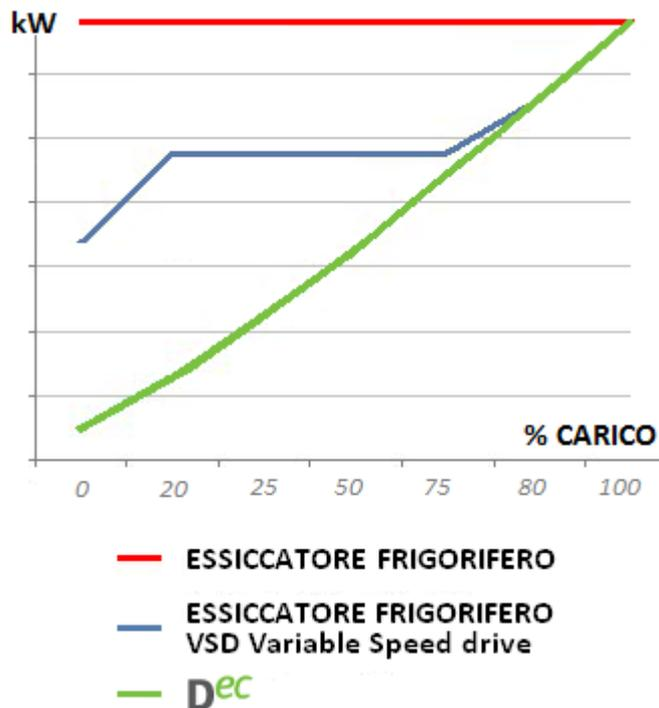
Grazie alla consolidata esperienza di progettazione, l'essiccatore D<sup>ec</sup> di Ingersoll Rand prevede peculiarità quali la massa termica, il controllo a microprocessore ed il drenaggio elettronico di tipo "No-Loss", che aumentano l'affidabilità dell'apparecchiatura.
